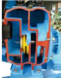
Pompe centrifuge bi-turbine développée par BERTHOUD alliant débit et pression :
