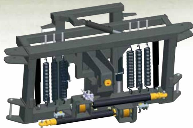
La rampe est équipée d'un dispositif anti-fouettement indépendant bras par bras. Ce système permet d'amortir le fouettement horizontal lors des phases d'accélération et de freinage afin de préserver la structure de rampe.
