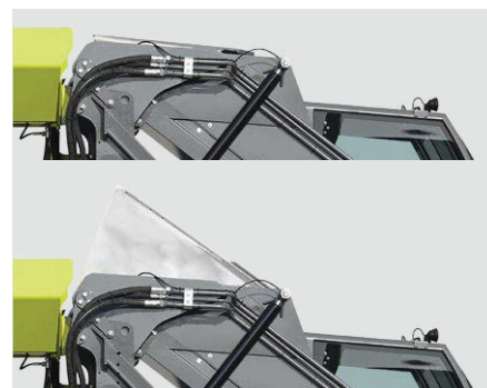
Deflettore idraulico per evitare perdite di prodotto in giornate con molto vento Hydraulic deflector to prevent product leakage on very windy days Hydraulicky ovládaný deflektor zabráňující únikům materiálu za větrných dnů
