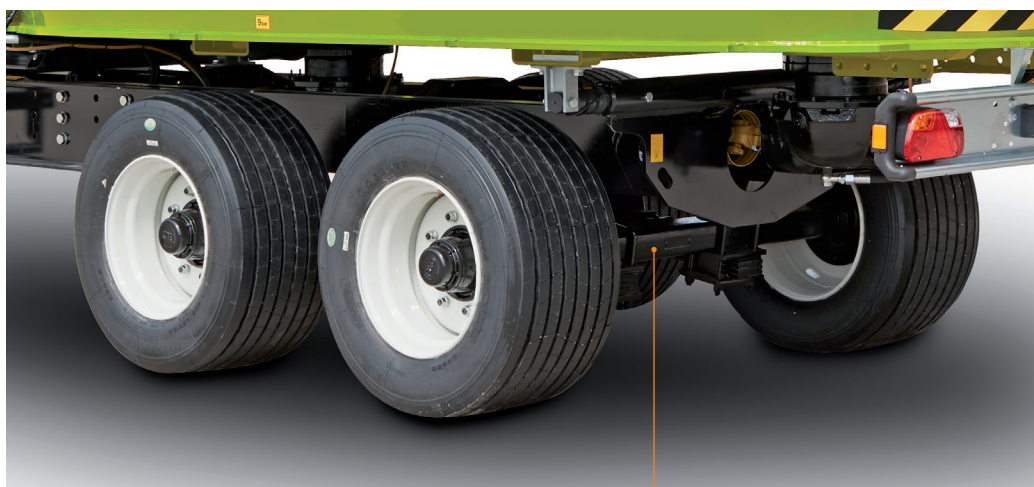
Nuovo bogie balestrato, disponibile in versione fissa ed autosterzante sia sui dunker T2S che T2L New sprung bogie, available also in self-steering version, both on dunker T2S and T2L Nowe resorowane podwozie tandemowe również z samosterowną osią, dostępne w modelach T2S i T2L
